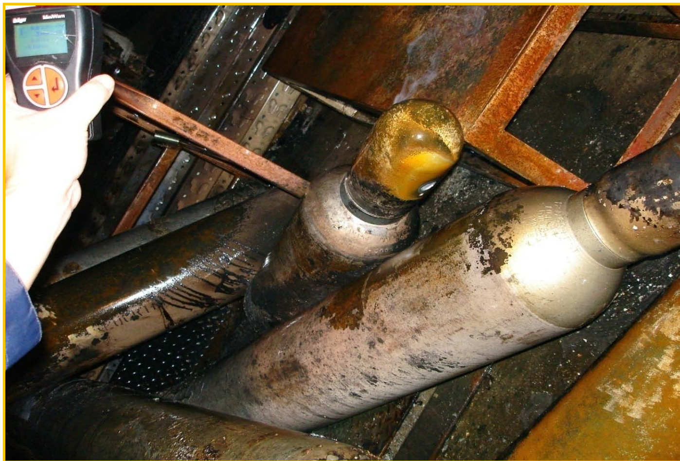
以四用氣體測量微漏之鋼瓶， 確認其物質為一氧化碳
