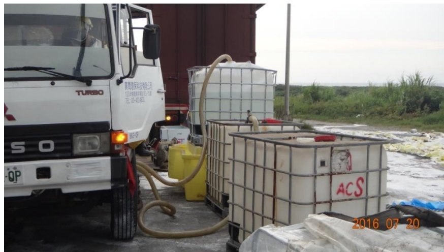
以隔膜泵浦進行移槽
