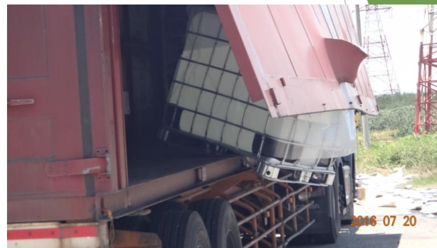
IBC TANK撞破卡住右側鷗翼
